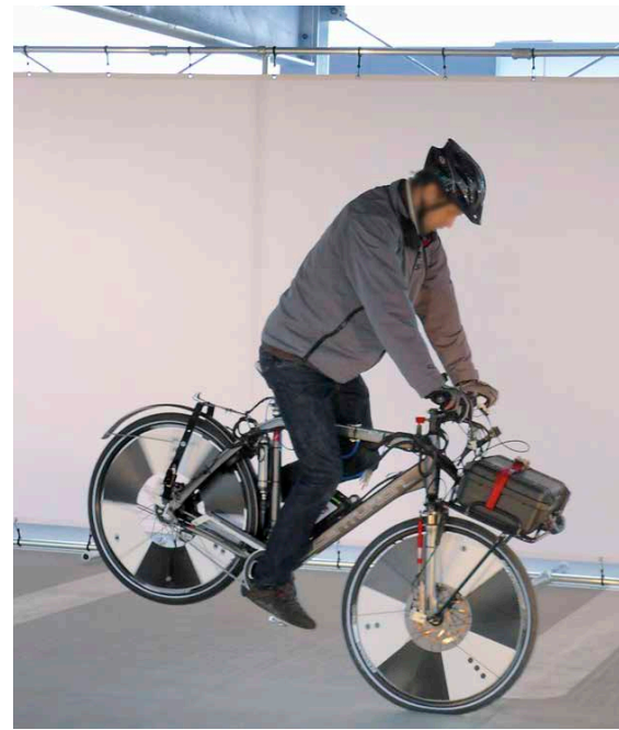
Gehören zur Konzeption des ABS-Systems dazu: reale Versuchsbremsungen bis zum Kippunkt
